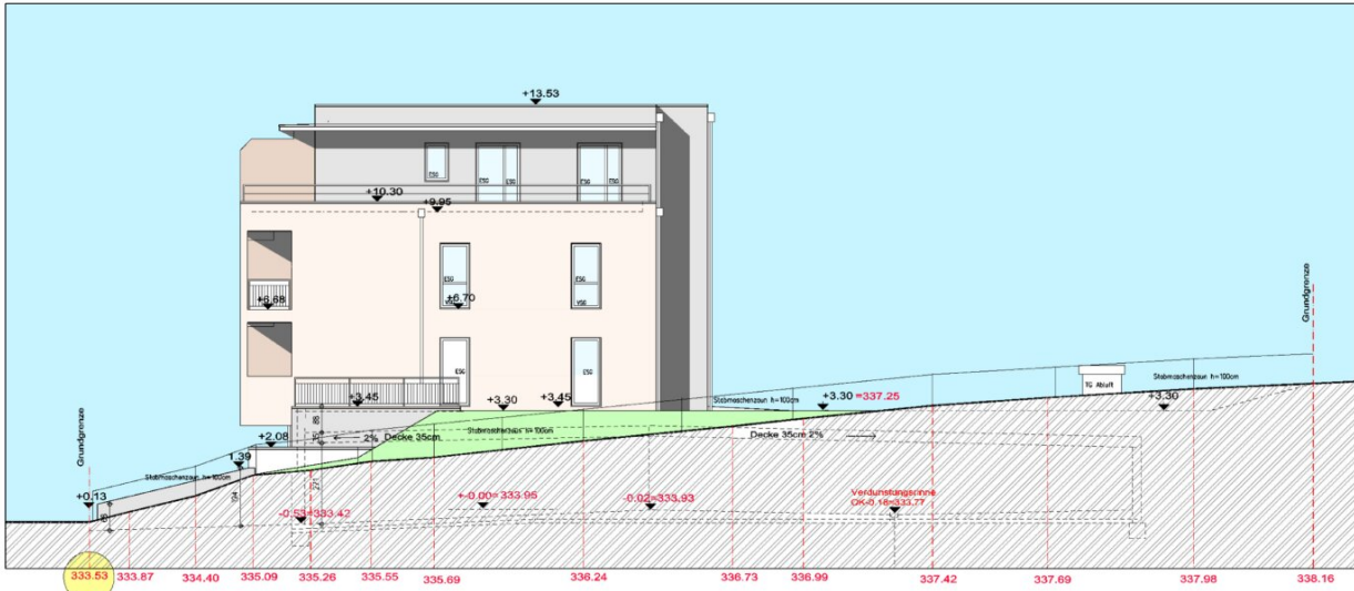
NORDOSTANSICHT mit Strassenprofil = Naturaufnahme
